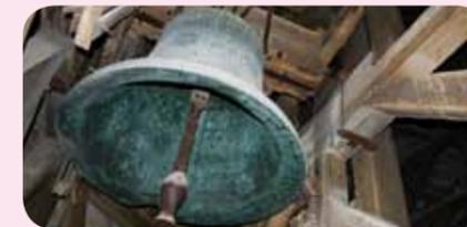
Dans un carillon, c'est le battant qui bouge, actionné par le clavier. Il vient frapper la cloche pour émettre le son
